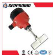
Sensor de nivel rotatorio Cuerpo metálico. Alimentación 220VAC Salida relé NA + NC Sensibilidad ajustable. Rosca de montaje 1"
